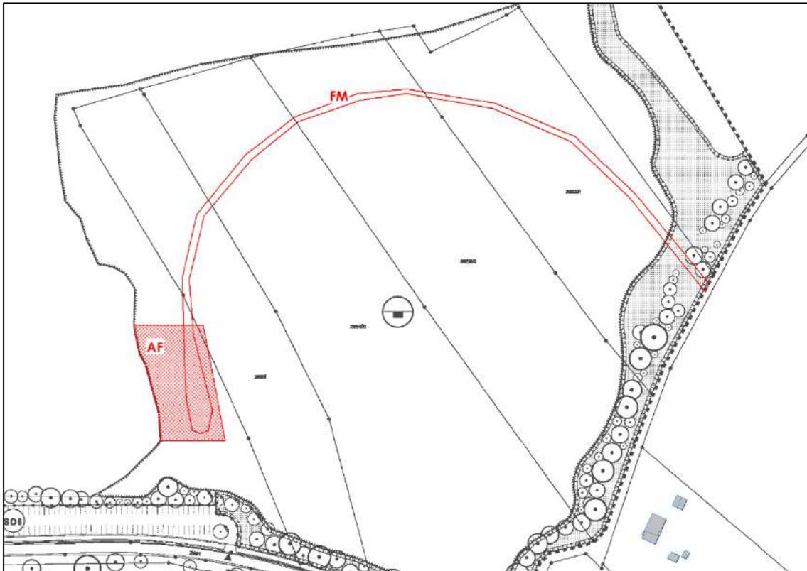
Abbildung 13: Lageplan mit Darstellung der relevanten Schallquellen des Kiesabbaus
